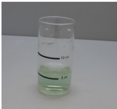
Figura 3. Acqua in uscita dall'impianto di addolcimento - durezza 0 °HF
