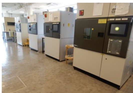
Figura 4. Xenon tester in uso presso il CATAS
