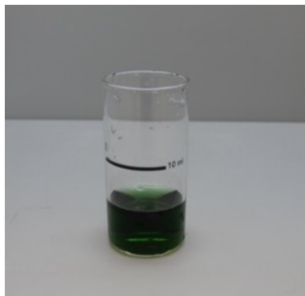
Figura 2. Acqua in arrivo dall'acquedotto - durezza 26 °HF
