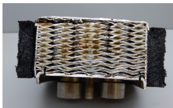
Figura 5. Incrostazioni di calcare verificatesi in uno scambiatore di calore con temperatura di esercizio di 55°C
