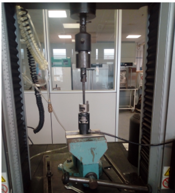
Foto 1. Il momento della verifica. I due funghetti, incollati tra loro sono posizionati al dinamometro e contemporaneamente collegati allo strumento Pull-off tester.
