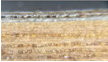
Figura 66. Pressione non sufficiente, linea adesivo non chiusa.
