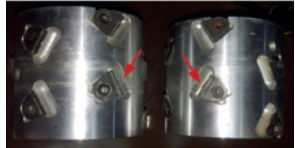
Figura 72. Esempio di utensili della rettifica usurati.
