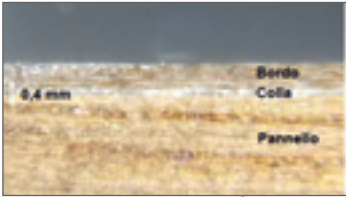
Figura 67. Pressione corretta, linea adesivo chiusa.
