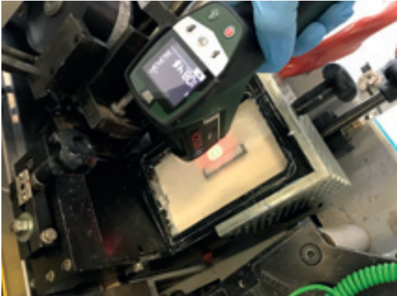
Figura 56. Termometro a infrarossi per controllo della temperatura in superficie (non idoneo per controlli in profondità).
