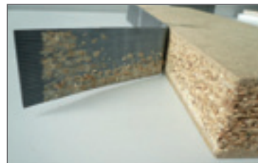
Figura 65. Esempio di incollaggio con rullo applicatore non in squadro.
