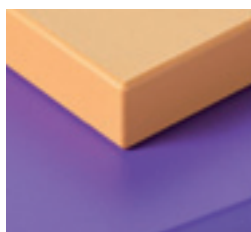
Figura 80. Esempio di bordo perfettamente lavorato senza "battute".
