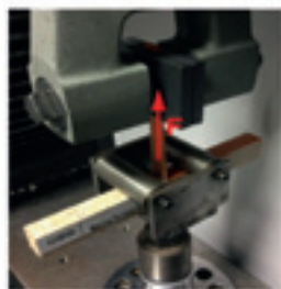
Figura 43. Esecuzione della prova di peeling a 90°.
