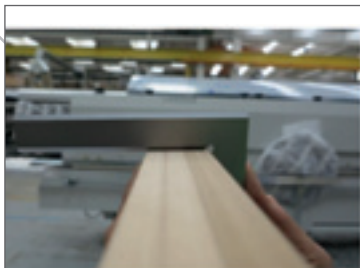
Figura 74. Esempio di pannello alto 45 mm rettificato con frese perfettamente in squadro.
