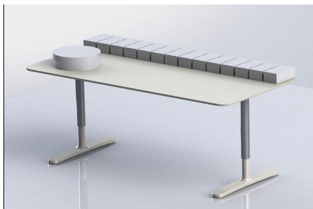
Fig.5: prova di durata dei sistemi di regolazione in altezza par.15
