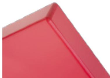
Figure 21. Correctly glued edge
