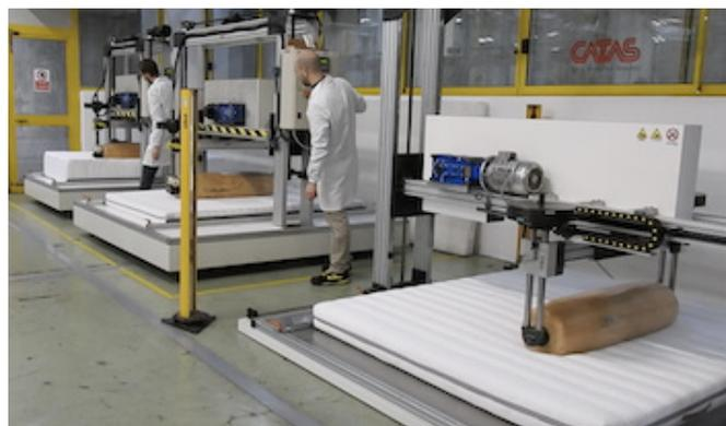
Prima e dopo la prova di fatica si procede alla rilevazione dell'altezza del materasso e per mezzo di una elaborazione matematica della curva carico-affondamento, si determina il grado di rigidità Hs (la sensazione di “morbido” o “duro” di cui abbiamo accennato sopra). Il valore di Hs è rapportato su una scala da 1 a 10, dove 1 identifica un materasso molto rigido e 10 uno molto morbido.
