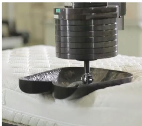
Per valutare se le eventuali variazioni dell'altezza e del grado di rigidità (Hs) riscontrate dopo le prove siano accettabili, si utilizza la norma italiana UNI 10707 "Materassi - Metodi di prova e requisiti".
