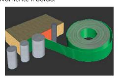
Fase 5: sgrossatura superiore e inferiore del bordo che Fase 6: asportazione dell'eccedenza di bordo rappresenta già un'operazione di finitura nel caso di superiore e inferiore lasciata dal gruppo di sgrossatura bordi in legno massello. Quantità residua al termine attraverso il processo del gruppo "spigolatore". massello: 0 mm.
