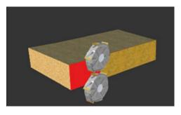
Fase 3: incollaggio del bordo attraverso il gruppo Fase 4: taglio dell'eccedenza del bordo anteriore e incollatore, in grado di applicare prima l'adesivo e posteriore attraverso due lame facenti parte di uno successivamente il bordo.
