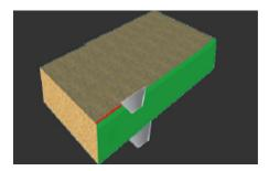
Fase 9: pulizia e lucidatura delle superfici lavorate attraverso due motori dotati di spazzole che operano insieme al liquido pulente.
